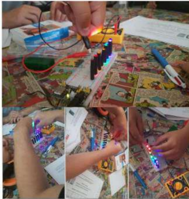
Figura 124. Verificação da ocorrência de variação do valor da diferença de potencial na tela do multímetro, com os LEDs conectados.
