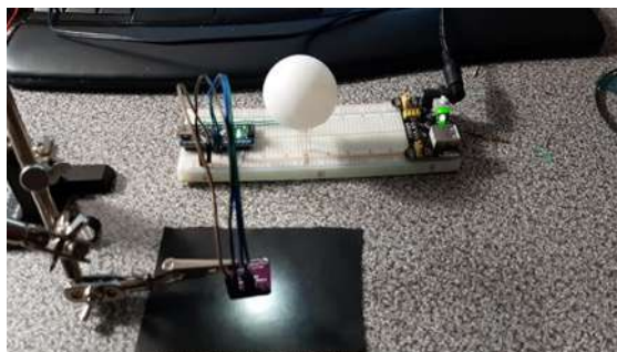
Figura 89. Sensor de cores TCS3200 captando a cor preta. Fonte: Elaborada pelo autor.
