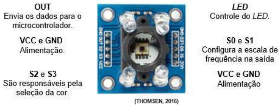
Figura 88. Componentes do sensor de cores TCS3200. Fonte: Elaborada pelo autor.
