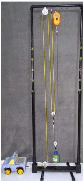
Figura 141 - Associação de polia móvel com balança no primeiro pitão
