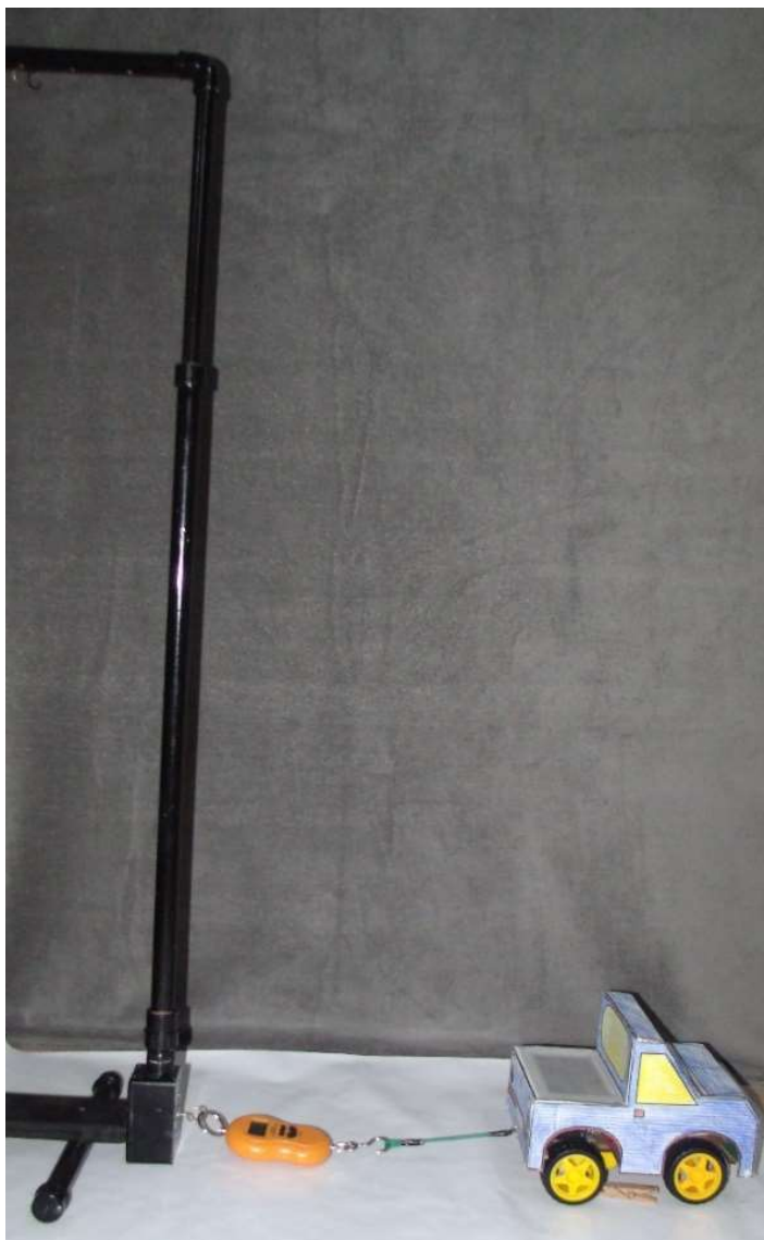
Figura 118 - Medindo a força de tração
