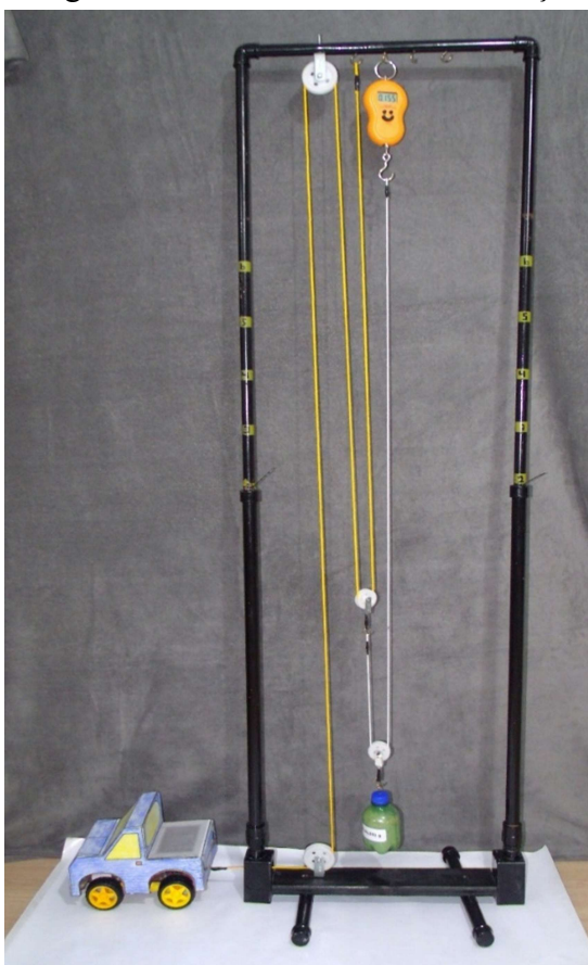
Figura 135 - Polia móvel com balança
