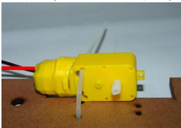
Figura 54 - Braçadeira plástica no local de fixação na parte frontal.
