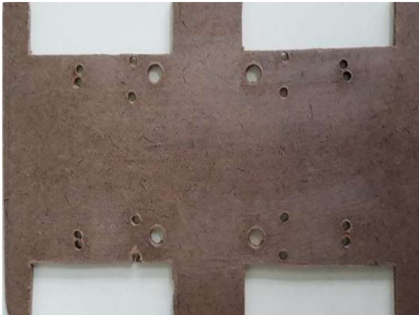
Figura 51 - Base do carrinho controlado remotamente cortada manualmente.
