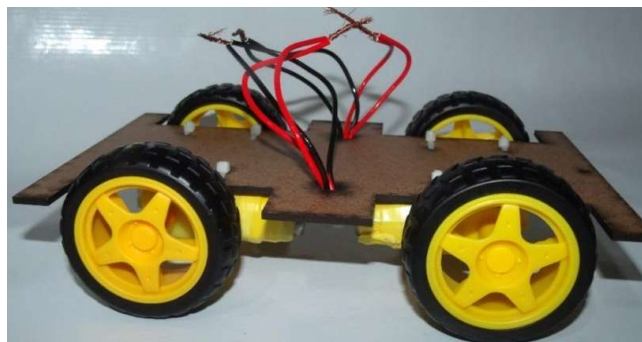
Figura 62 - Colocação das rodas.
