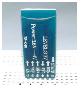
Figura 69 - Módulo bluetooth pinado na protoboard.
