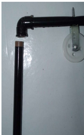
Figura 108 - Fixação do cano de suporte ao joelho de 90°.
