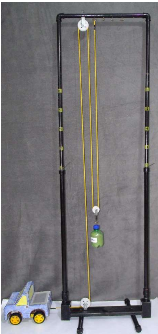
Figura 126 - Movendo peso com polias móveis.
