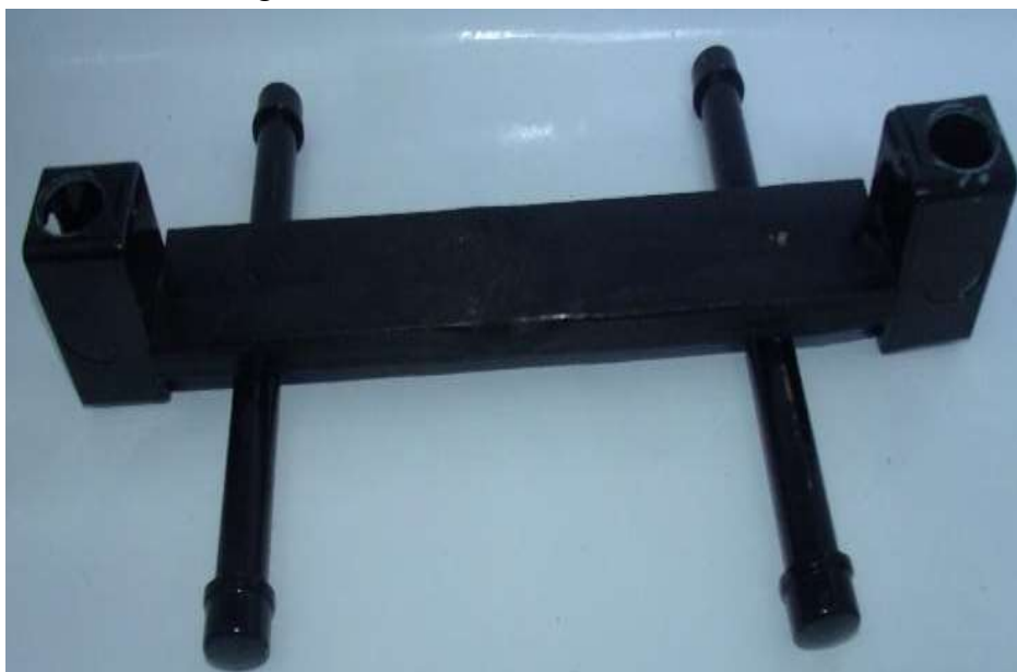
Figura 94 - Base com condutores fixados.
