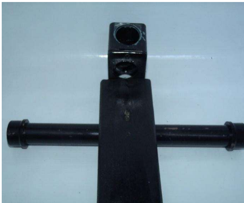
Figura 93 - Fixação da caixa do condutele na base.
