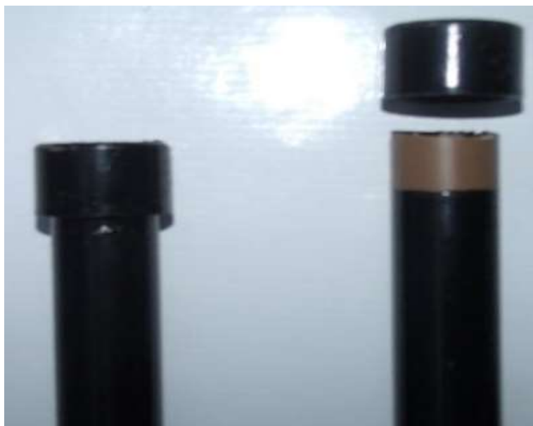
Figura 95 - Colocação das buchas de redução nos canos.
