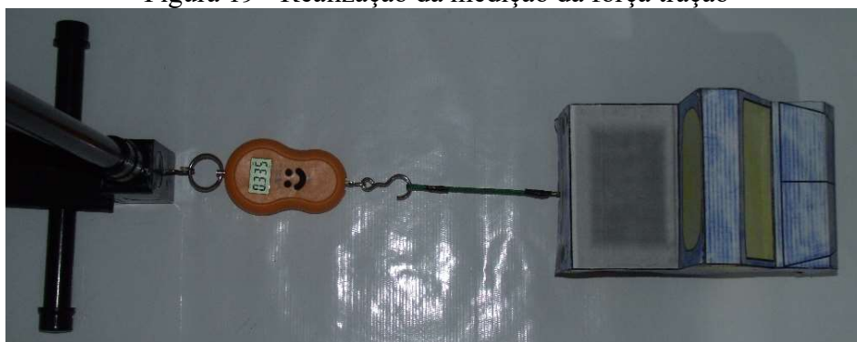
Figura 19 - Realização da medição da força tração
