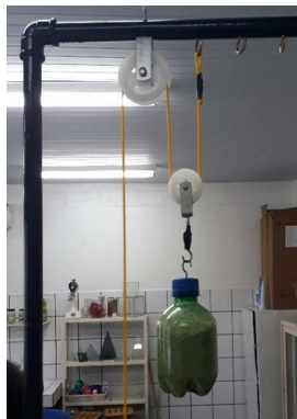
Figura 20 - Aparato com polia fixa e móvel.
