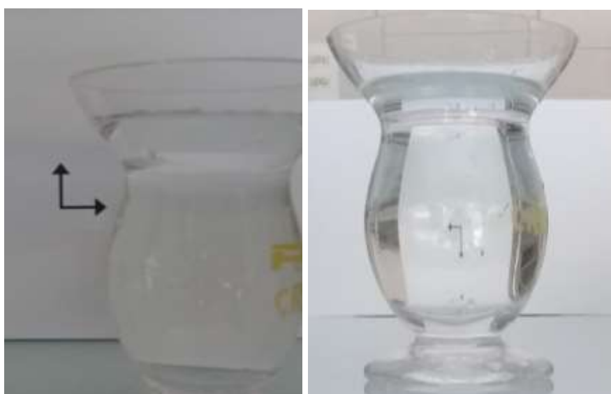
Figura 33. Imagem real, inversão da seta no eixo x e no eixo y .
