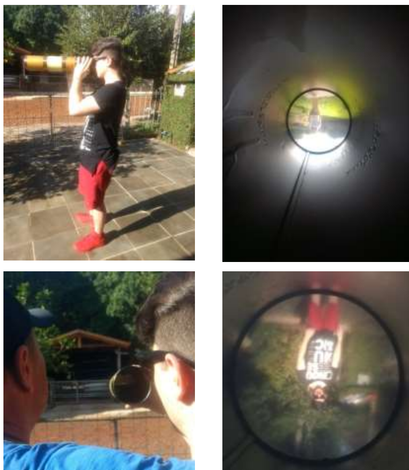
Figura 38. Observação da imagem invertida através da câmara escura.
