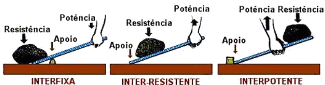
Figura 25. Alavanca interfixa, inter-resistente e interpotente.
