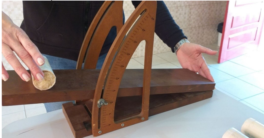
Figura 9 - Rampa de madeira com início do rolamento do tubo de PVC
