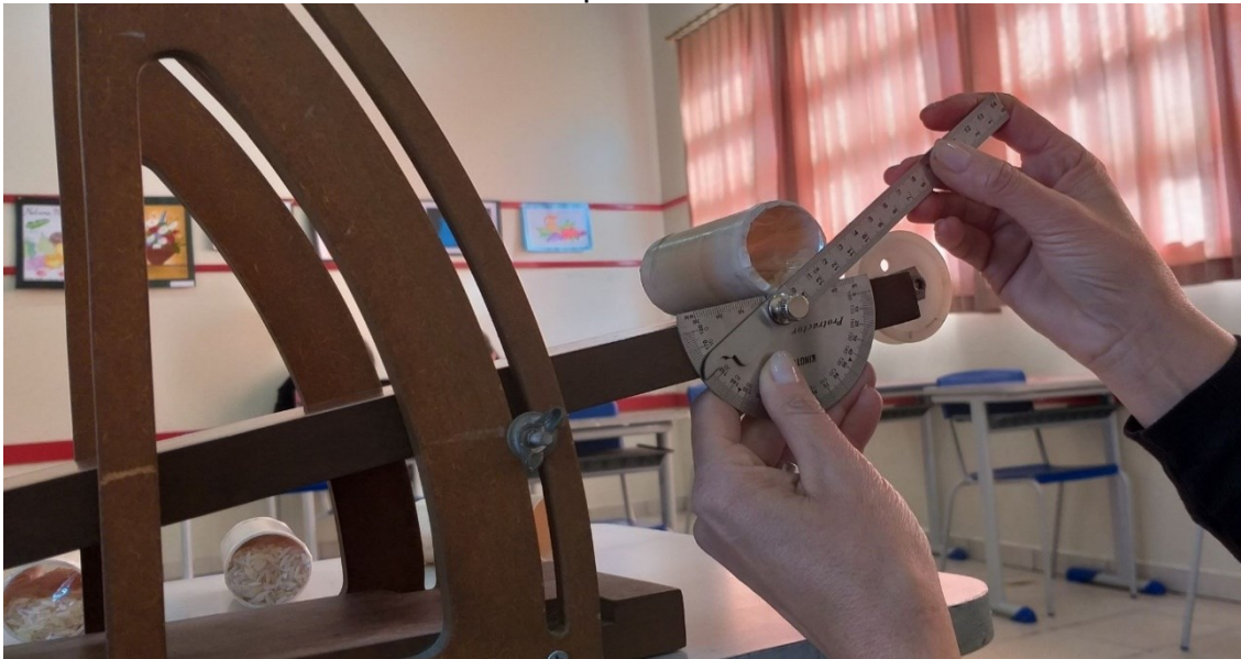
Figura 12 - Medição com o goniômetro do ângulo de equilíbrio do tubo de PVC em equilíbrio
