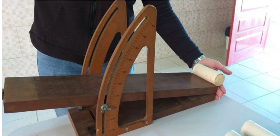
Figura 10 - Rampa de madeira com o fim do rolamento do tubo de PVC
