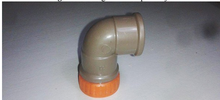
Figura 5: Colagem da tampa no “joelho”.
